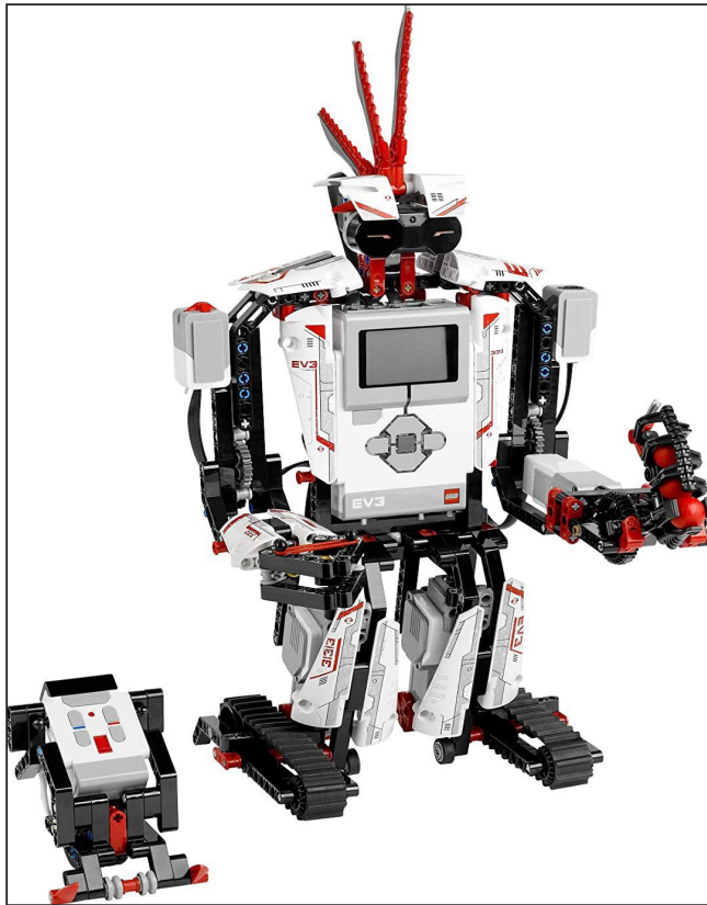
Figura 2 - Robô desenvolvido com peças do Kit Lego Mindstorms
