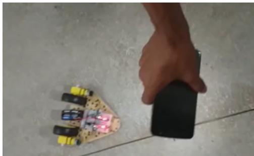
Figura 14 – Manipulação do artefato utilizando luz para ativar o movimento
